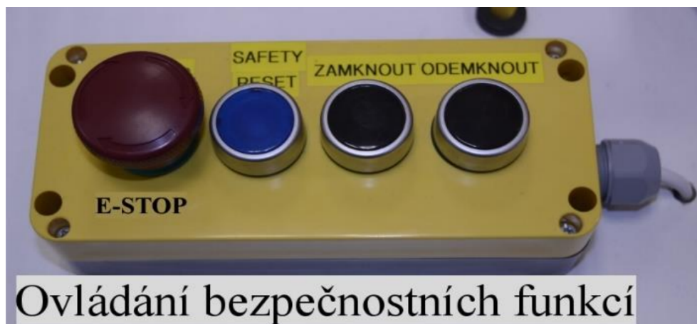
Obrázek 1: Tlačítka E-STOP, Safety Reset, Zamknout a Odemknout[1]
